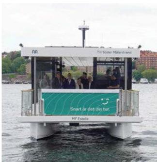
Die autonome E-Fähre wird von vier Elektromotoren mit jeweils 10 kW Leistung betrieben
