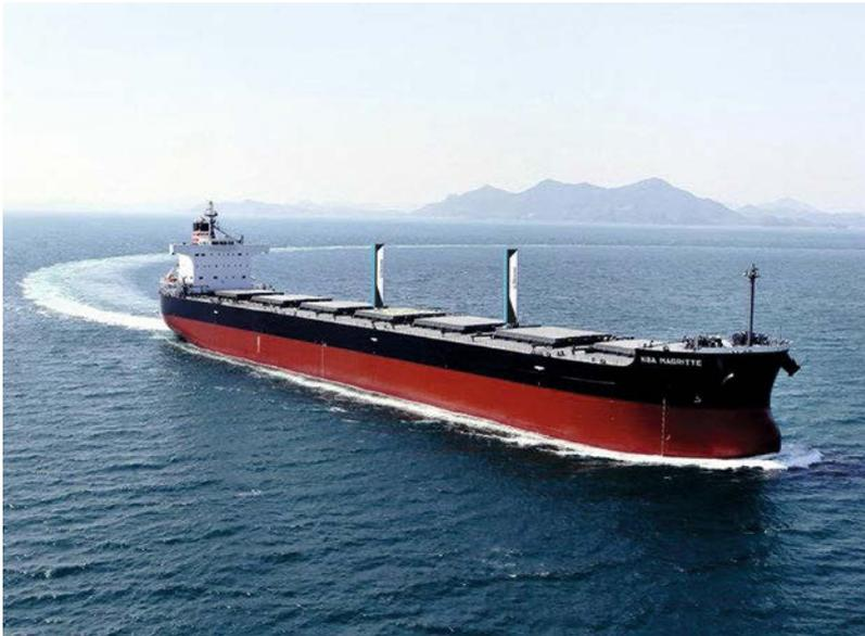
Der Ventofoil-Windzusatzantrieb wird an Bord eines NYK-Massengutfrachters installiert
