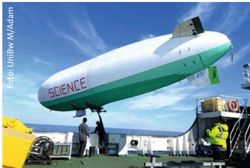
Mithilfe eines 12 m langen Luftschiffes konnten ausgewählte Partikeleigenschaften direkt in den Emissionsfahnen von Schiffen gemessen werden
